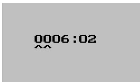
Используйте клавиши + и – для изменения указанной части значения моточасов. Используйте клавишу «Menu» для перехода от сотен часов к часам, и от часов к минутам.
